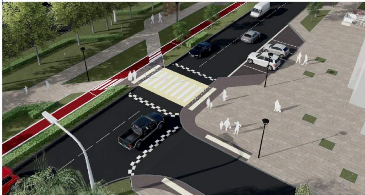
Узел В Нерегулируемый пешеходный переход и въезд на придомовую территорию
